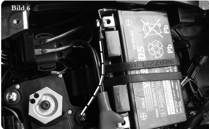
11. Verbinden Sie das schwarze Kabel des Pk-Power Dragon Kabelbaums mit dem Minuspol der Batterie (siehe Bild 6)
