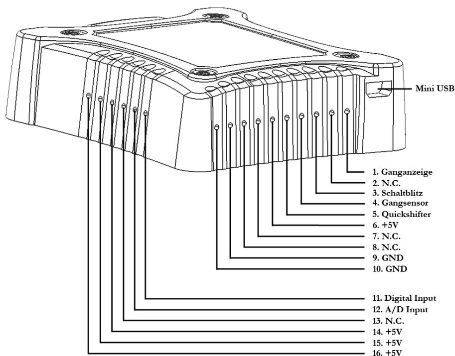
1. **Ganganzeige** – Dieser Anschluss ist ausschließlich für eine Pk-Power Ganganzeige geeignet. Diese Ganganzeige wird voraussichtlich ab 2012 verfügbar
